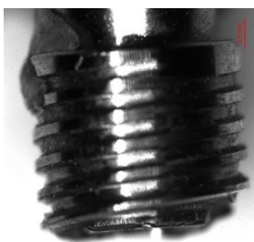
Figura 3 Frattura implantare a 240 N a livello della 6ª spirale (BONE LEVEL).
