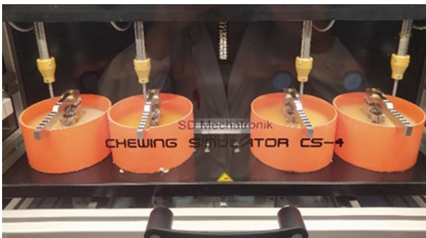
Figura 2 Quattro campioni vengono testati in soluzione salina tramite un simulatore di cicli masticatori (Unibo). I vettori di carico impartiti ai campioni riflettono il peggior caso possibile che potremo trovare clinicamente ISO14801/2016).
